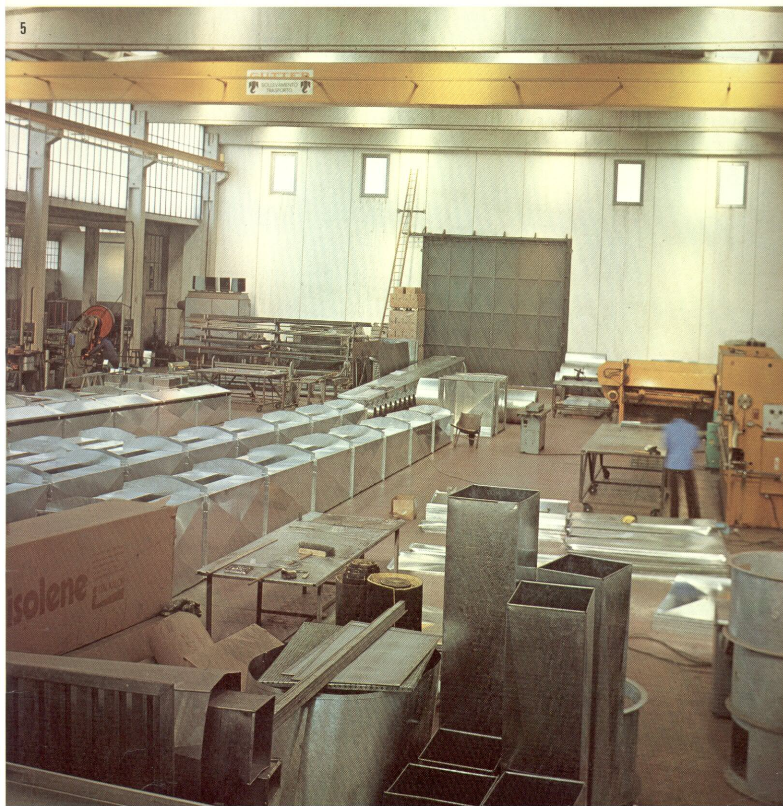
5) Reparto lavorazione lamiere per la costruzione di condotti per trasporto aria ad uso impianti di condizionamento e termoventilazione.
